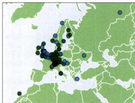
Bild 1: Auswertung der WSPR-Empfängsergebnisse auf 80 m im DXplorer; grün sind die Empfänger markiert, die sowohl die Station mit Dipol als auch die mit der 80-m-Eigenbauantenne aufnehmen konnten.
