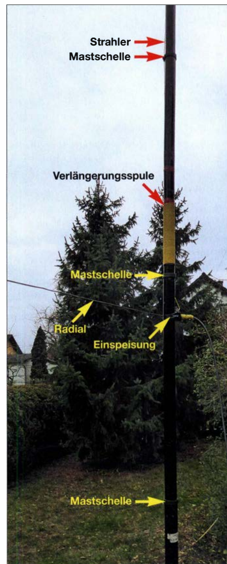
Bild 11: Unterer Teil der als Winkeldipol an einem 12-m-GFK-Mast aufgebauten Vertikalantenne für 160 m Fotos: DL7VEE
