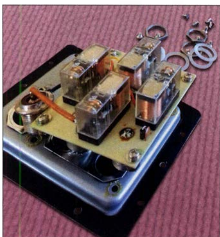
Bild 1: Der Antennenumschalter Yaesu FAS-1-4R lässt sich einfach demontieren und ist intern sehr übersichtlich aufgebaut.
