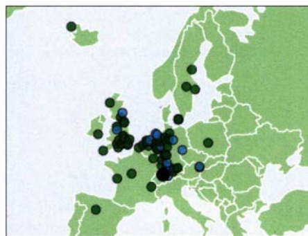
Bild 2: Analog zu Bild 1 hier die Empfänger auf 160 m, die die WSPR-Aussendungen des Dipols und der 160-m-Eigenbau-Antenne aufgenommen haben; der eigene Standort ist wiederum schwarz markiert.
