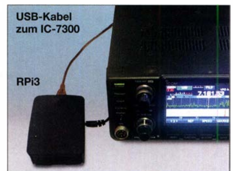
Bild 9: Raspberry Pi 3B mit Stromversorgungskabel und USB-Kabel zum IC-7300
