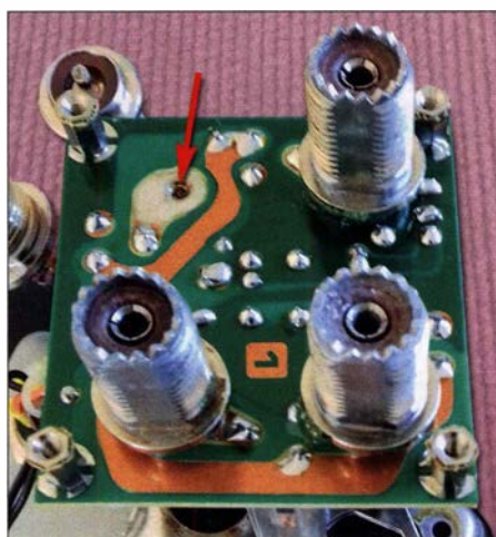
Bild 2: Wegen des abgebrochenen Kontakts (Pfeil) fehlt der SO239-Buchse die Verbindung zur Relaisplatine. Fotos: DL3MCO
