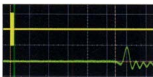
Bild 7: Zur Messung des NPR wurde der Frequenzgang einer Rauschquelle mit einer 5 kHz breiten Lücke versehen.
