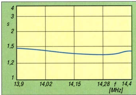
Bild 4: SWV-Verlauf im 20-m-Band, gemessen am Antennenfußpunkt
