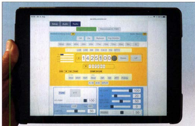
Bild 1: Fernsteuerung des IC-7300 Transceivers über iPad mit RemoteTx Screenshots und Fotos: DC4KU
