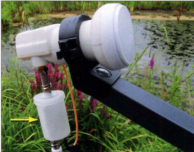
Bild 1: Die Außeneinheit der Fernspeiseweiche besteht aus nur wenigen Bauelementen und lässt sich wettergeschützt z. B. in einer Kunststoff-Filmdose in unmittelbarer Nähe des LNB unterbringen.
