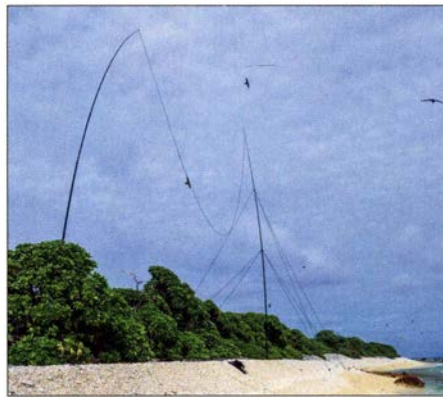
Im Vordergrund unsere unmittelbar am Pazifikstrand aufgebaute 160-m-Antenne
