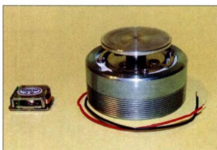
Bild 4: Körperschallwandler mit unterschiedlicher Belastbarkeit, links 2 W, rechts 6 W
