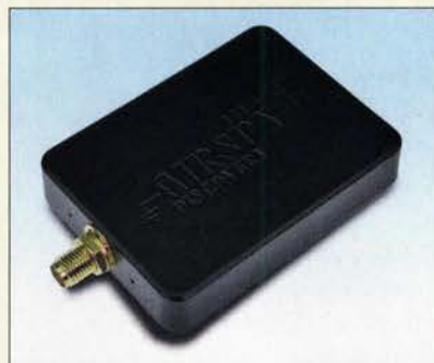
Der Airspy HF+ Discovery hat gegenüber dem Airspy HF+ nur einen Eingang und ein Kunststoffgehäuse, jedoch einen nach unten erweiterten Frequenzbereich.
